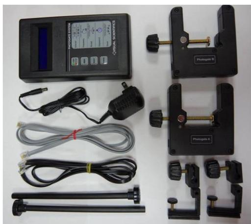
圖片說明：編號 16. 計時器 P-CA168 光電計時器
