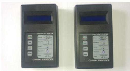
圖片說明：編號 17. 計時器 P-CA168 光電計時器
