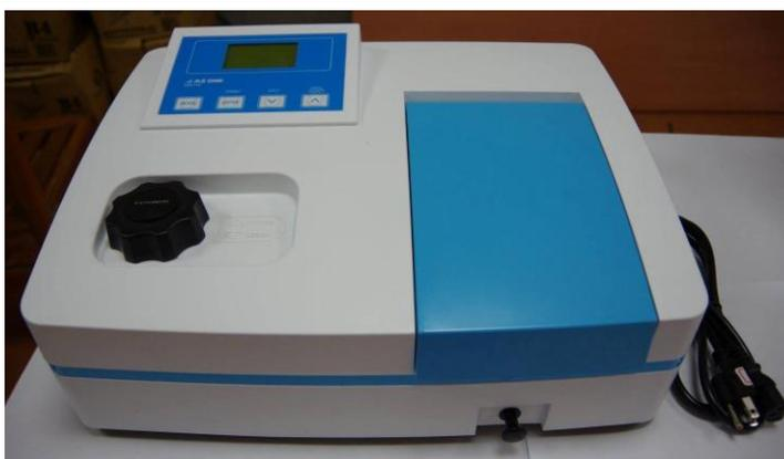
圖片說明：編號 14. 紫外線/可見光分光光度計 C-F6219
