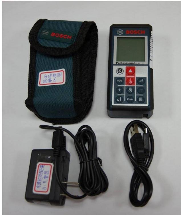
圖片說明：編號 24. 多功能測距儀 N-GLM100 多功能雷射
